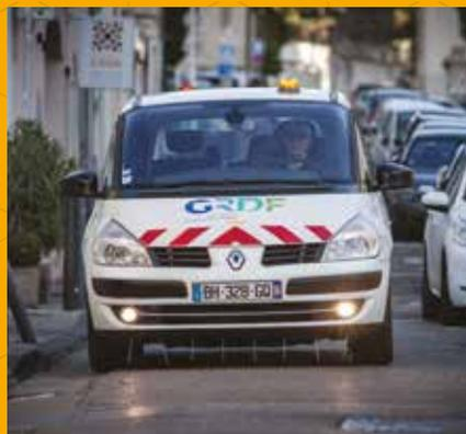
La surveillance des réseaux de distribution de gaz naturel, est assurée par GRDF, à l'aide d'un Véhicule de Surveillance des Réseaux. La partie avant du véhicule est équipée de huit sondes lasers qui aspirent l'air ambiant afin de
